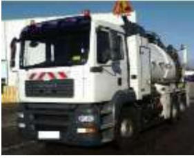
Hydrocureuse Niveau de bruit constructeur < 80dB
