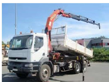
Camion-grue de 19 tonnes
